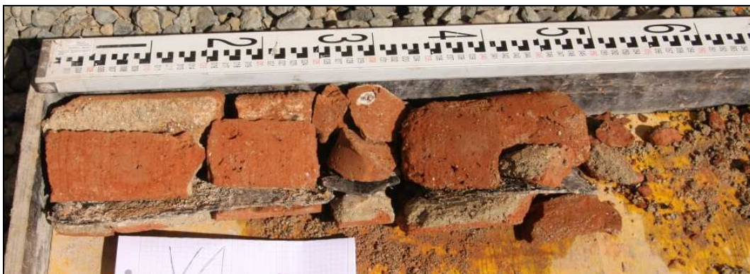
Obr. č. 69 – Jádrový vrt V1 – izolace prochází celou tloušťkou stěny.
