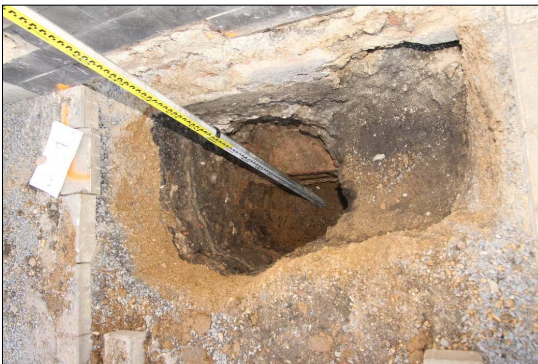
Obr. č. 48 - kopané sondy u líce zdiva, sonda KS1, detail sondy
