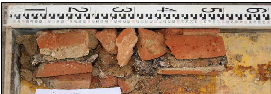
Obr. č. 70 – Jádrový vrt V2 – izolace prochází celou tloušťkou stěny.
